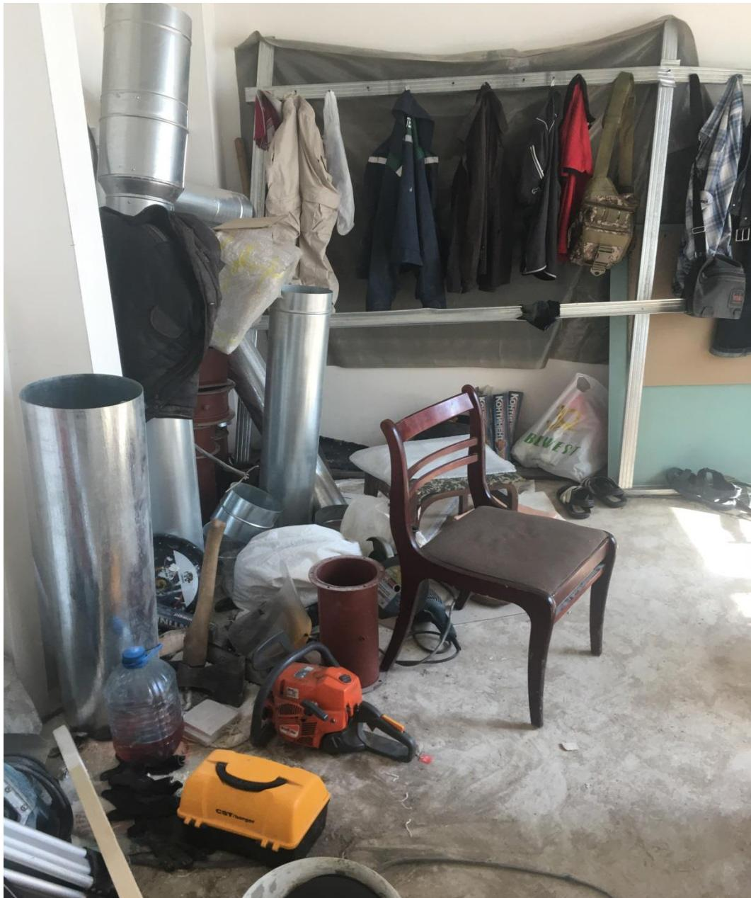
Электроинструмент не храниться в сухом помещении, оборудованном специальными стеллажами, полками, ящиками, обеспечивающими его сохранность
